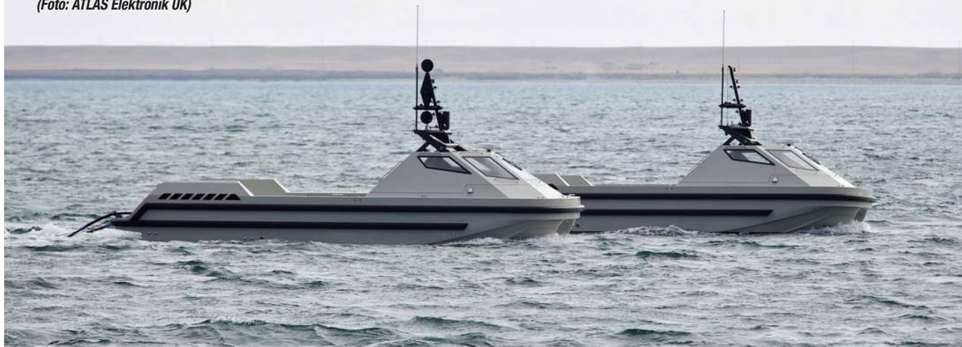
Unbemannte Überwasserplattformen, hier die Atlas Remote Capability Integration Mission Suite (ARCIMS), eignen sich für komplexe Aufgaben in der Minenjagd. (Foto: ATLAS Elektronik UK)
