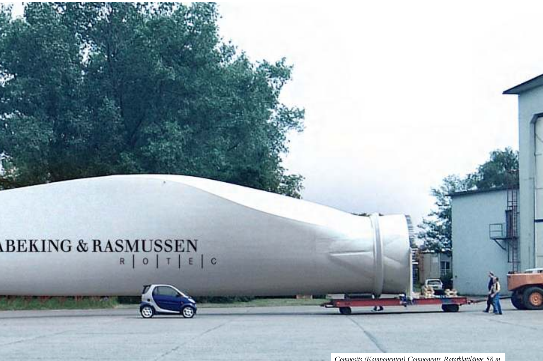
Composites (Komponenten) Components, Rotorblattlänge 58 m
